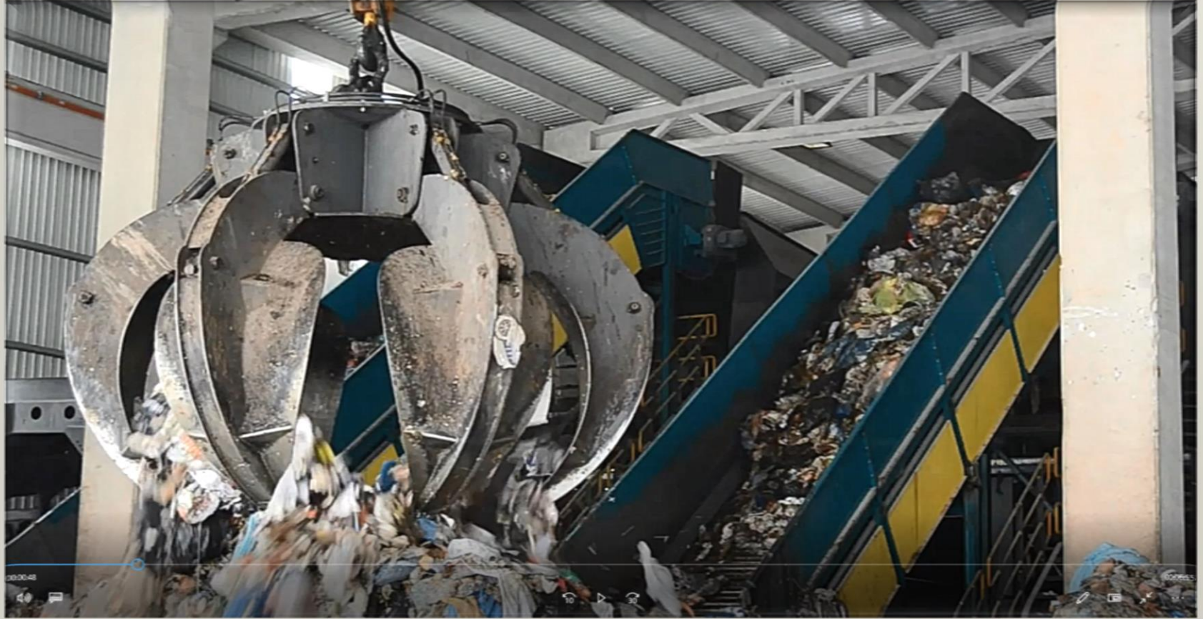
Kapma atığı elik konveyörlere aktarıyor
